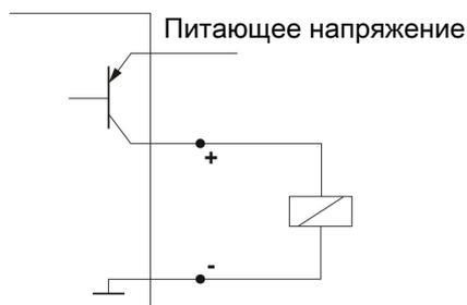
**Указание:** При измерениях переключающего выхода с высокоомными входами измеряемых приборов или при использовании в качестве частотного выхода во избежание ошибочных измерений необходимо подключать сопротивление 10 кΩ между выходом и массой (GND).
