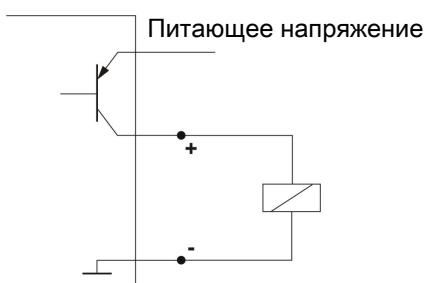
**Указание:** При измерениях переключающего выхода с высокоомными входами измеряемых приборов или при использовании в качестве частотного выхода во избежание ошибочных измерений необходимо подключать сопротивление 10 kΩ между выходом и массой (GND).
