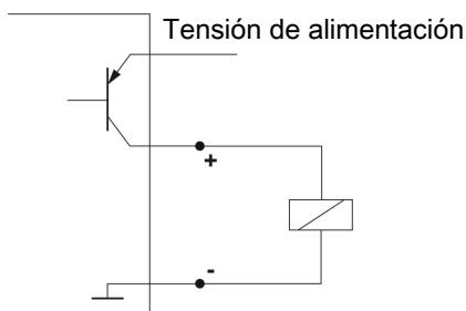
**Aviso:** Al medir la salida de conmutación con entradas de dispositivos de medición de gran resistencia o al aprovechar la salida de frecuencia se conmutará una resistencia 10 kΩ entre la salida y la masa (GND) para evitar mediciones erróneas.
