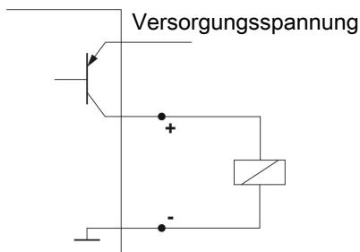
**Hinweis:** Bei Messungen des Schaltausgangs mit hohohmigen Messgeräteeingängen oder bei Nutzung als Frequenzausgang ist ein 10 kΩ Widerstand zwischen Ausgang und Masse (GND) zu schalten, um Fehlmessungen vorzubeugen.
