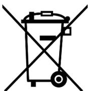
Das Symbol der durchgestrichenen Mülltonne weist darauf hin, dass die damit gekennzeichneten Elektro- und Elektronikprodukte vom Hausmüll getrennt entsorgt werden müssen. Sie müssen fachgerecht als Elektro- und Elektronikaltgeräte entsorgt werden.
