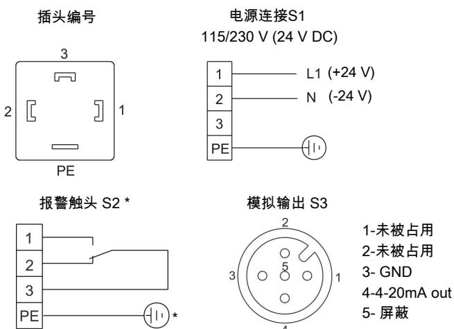
\* 在电压 $\geq 33 \text{ V AC}$ 或 $\geq 70 \text{ V DC}$ 下使用报警触点时请接地。
