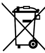
被划掉的垃圾桶的符号表示标有它的电器电子产品必须与生活垃圾分开处理。必须作为废弃的电气和电子设备妥善处理它们。
