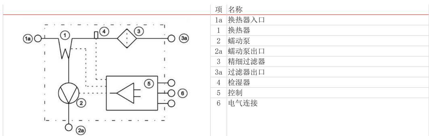
待处理的气体被直接输送至换热器（1, 1a）入口中。换热器的出口已与一精细过滤器（3）相连。直接从过滤器的出口，样气借助于软管接头（3a）被继续输送。
