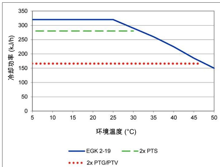
注释：换热器的极限曲线适用于40 ° C的露点下。
