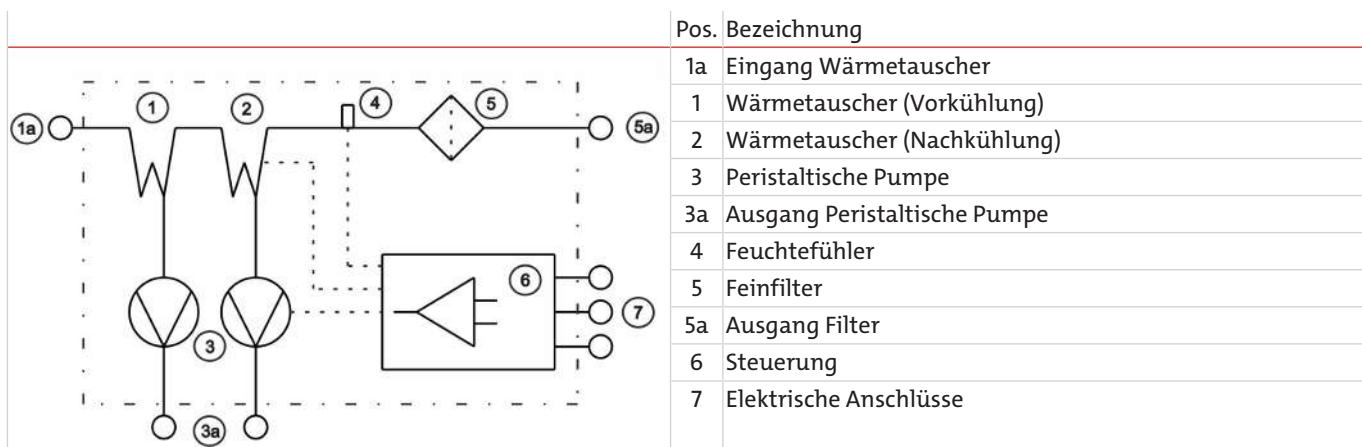
Das aufzubereitende Gas wird direkt in den Eingang des Wärmetauschers (1, 1a) eingespeist. Der Ausgang des Wärmetauschers (2) ist mit dem Feinfilter (5) vorverschlaucht. Die Weiterführung des Messgases erfolgt direkt vom Ausgang dieses Filters mittels einer Schlauchverschraubung (5a).
