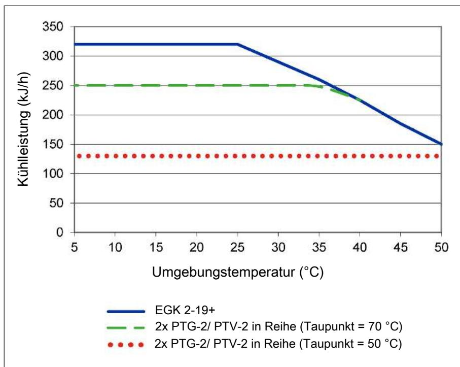
Anmerkung: Die Grenzkurven für die Wärmetauscher gelten bei dem Taupunkt von 70 °C unter Normbedingung entsprechend DIN EN 15267-3:2008-03 und beim Taupunkt von 50 °C unter Einsatzbedingung.
