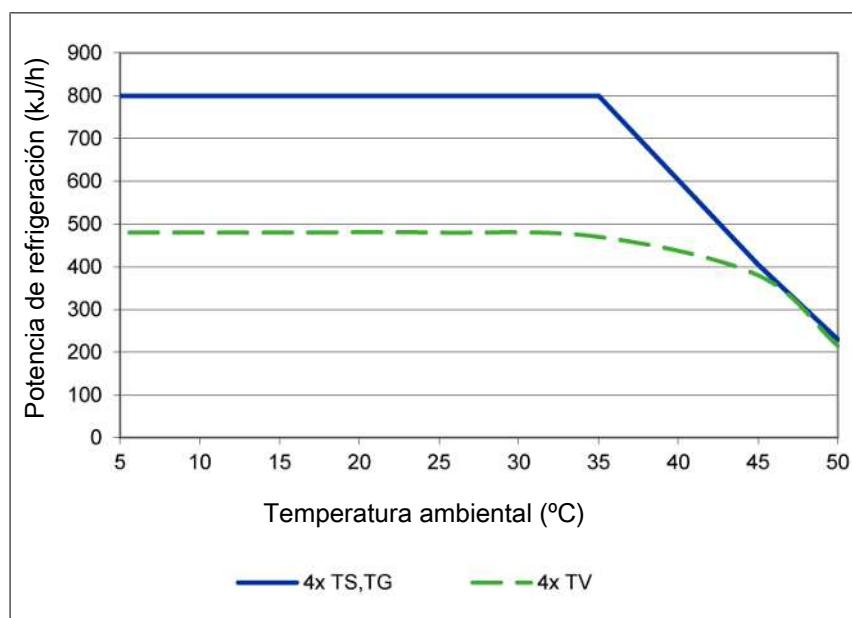
Observación: Las curvas límite para los intercambiadores de calor son aplicables con un punto de condensación de 65 °C.
