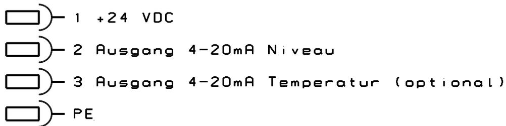
Ausführung mit Steckverbinder 4-polig M12x1 nach DIN EN 61076-2-201
