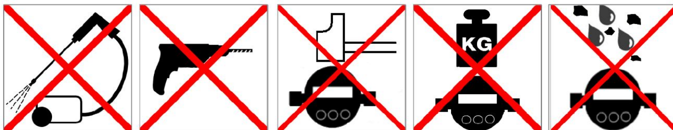
Abb. 8: Unzulässige mechanische Beanspruchung
