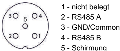
Abb. 1: Anschluss Kühler
