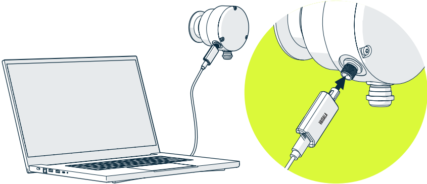
Abbildung 22 Verbinden des Refraktometers mit Insight
