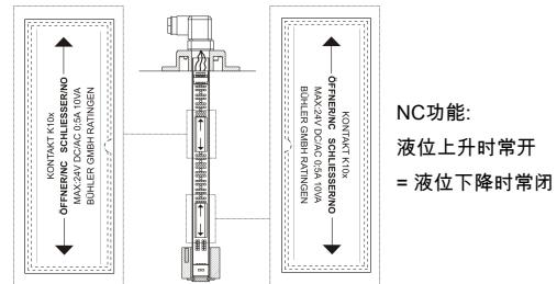
触点逻辑假定，液位开关安装在一空罐中，即灌装后才在工作位置。
