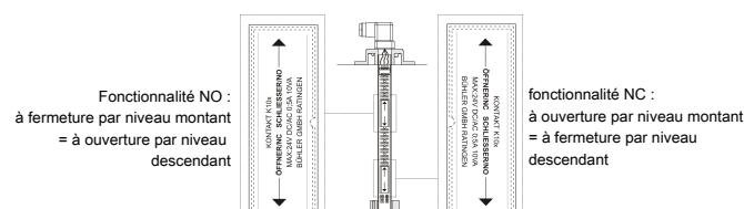
La logique de contact suppose que l'interrupteur de niveau est installé dans un réservoir vide, ce qui signifie sa mise en service après avoir été rempli.
