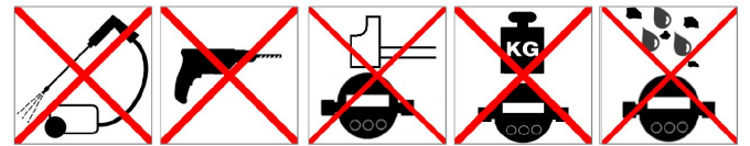
Изображение 4: Недопустимая механическая нагрузка
