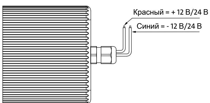
Изображение 2: Электрические подключения насоса P1.3
