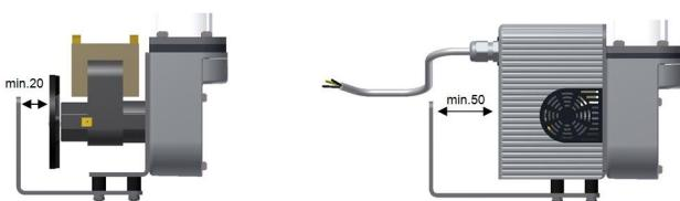
Lors du montage de la pompe pour gaz de mesure, assurer toujours une distance suffisante entre le moteur et la paroi arrière (20 mm).
