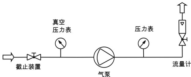
图1:一个合适的监测流程图例
