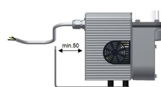
En el montaje de la bomba de gases de muestreo se ha de tener siempre en cuenta una distancia suficiente entre el motor y el panel trasero (20 mm).
