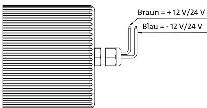
Abb. 2: Elektrische Anschlüsse P1.3 Pumpen
