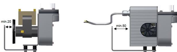
При монтаже насоса для анализируемого газа необходимо обеспечить достаточное расстояние от двигателя до задней стенки (20 мм).
