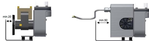
若安装样气泵，须始终确保从电机到后壁有足够的距离（20 mm）。
