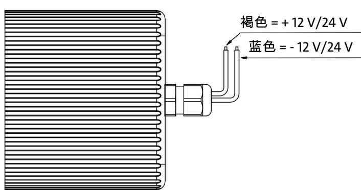
图2: P1.3泵电气连接
