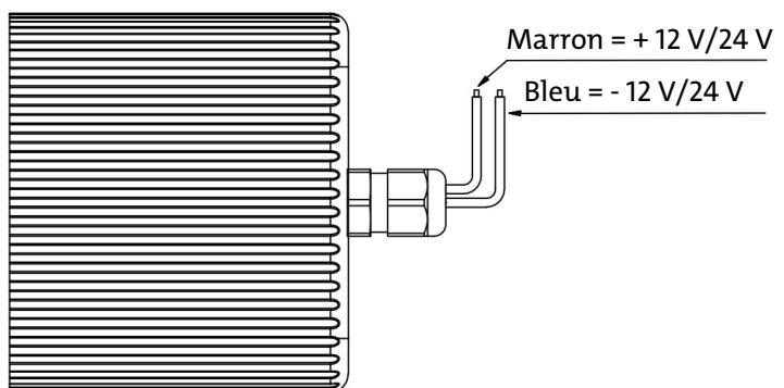
Fig. 2: Raccordements électriques de pompes P1.3
