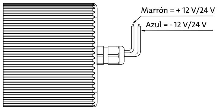
Ilustración 2: Conexiones eléctricas para bombas P1.3
