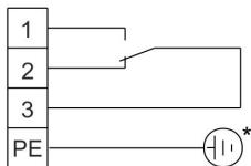
\* En cas d'utilisation du contact d'alarme sous tension  $\geq 33$  V AC ou 70 V DC, le conducteur de protection (PE) doit être raccordé.
