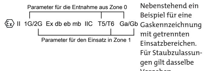
Beachten Sie, dass die Temperaturklasse für die Entnahmemezone 0 im Gegensatz zur Betriebszone reduziert ist. Dies ist auch an der Zündschutzkennzeichnung auf dem Typenschild ersichtlich.
