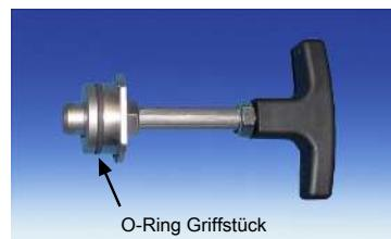
Einen für die zu erwartende Umgebungstemperatur geeigneten O-Ring auf das Griffstück einsetzen.
