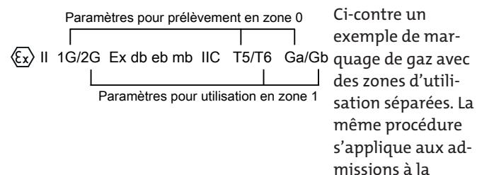
Notez que la classe de température pour la zone de prélèvement 0 est réduite par rapport à la zone d'exploitation. Ceci est également visible sur la plaque signalétique de la protection contre l'inflammation.
