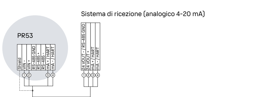
Figura 29 Schema elettrico per uscita analogica di PR53 e comunicazione HART opzionale
