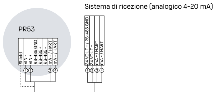
Figura 29 Schema elettrico per uscita analogica di PR53 e comunicazione HART opzionale
