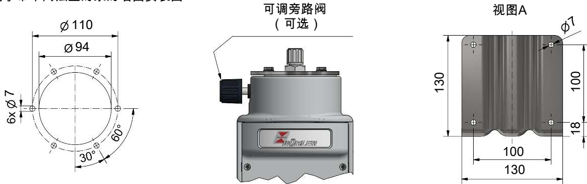
用于带中间法兰的泵的墙面安装图
