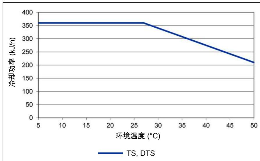
注释：换热器的极限曲线适用于65 ° C的露点下。
