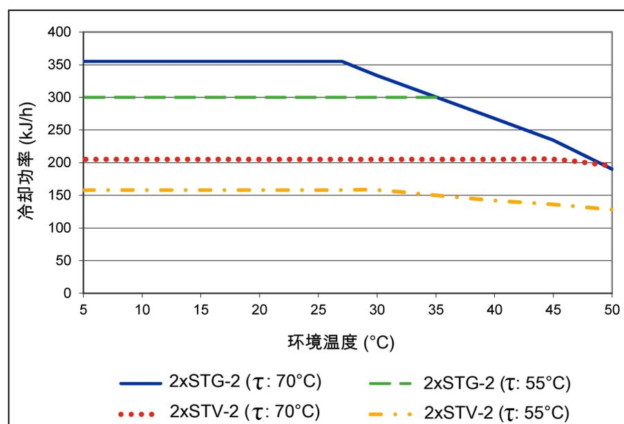
注释：换热器的极限曲线适用于不同的露点 ( $\tau$ ) 下，见图例。
