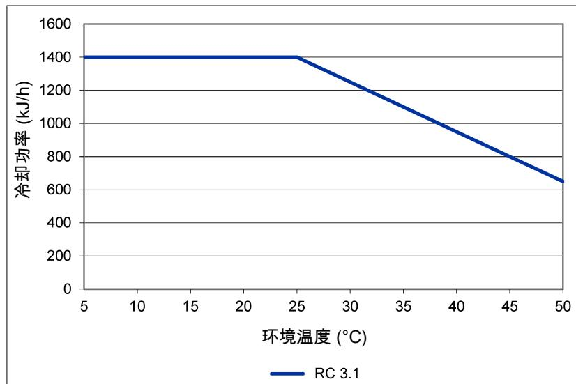
注释: 换热器的极限曲线适用于65 ° C的露点下。
