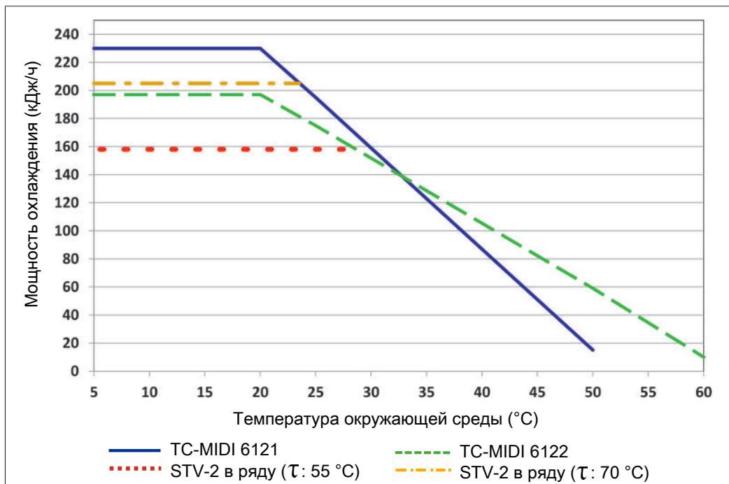
Примечание: Мощность теплообменника STG-2 соответствует максимальной мощности охлаждения охладителя.
