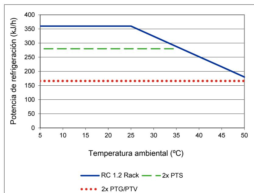
Observación: Las curvas límite para los intercambiadores de calor son aplicables con un punto de condensación de 40 °C.
