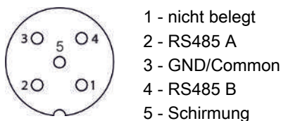
Abb. 1: Anschluss Kühler
