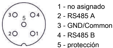
Ilus. 1: Conexión del enfriador
