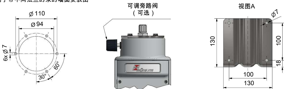
用于带中间法兰的泵的墙面安装图
