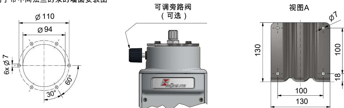
用于带中间法兰的泵的墙面安装图
