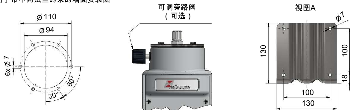
用于带中间法兰的泵的墙面安装图
