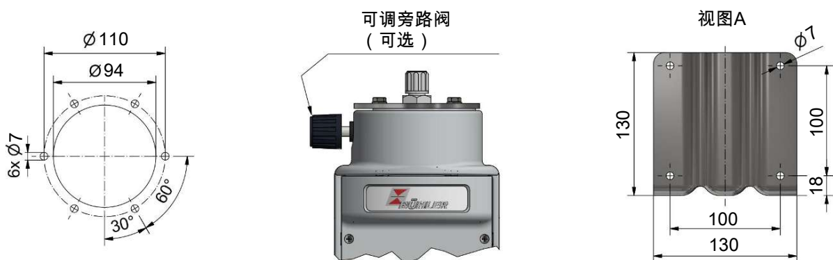
用于带中间法兰的泵的墙面安装图
