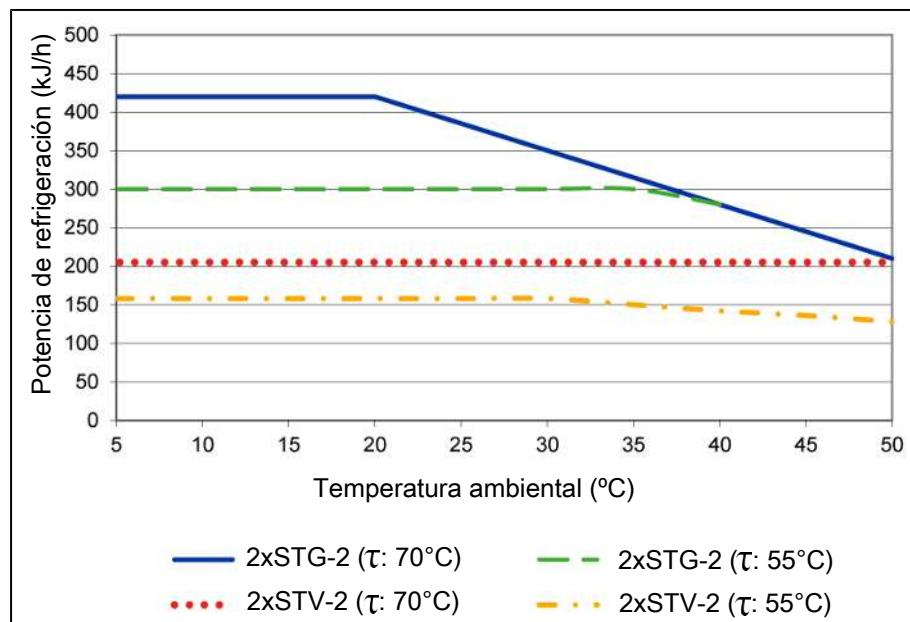
Observación: Las curvas límite para los intercambiadores de calor son aplicables con diferentes puntos de condensación ( $\tau$ ), ver leyenda.
